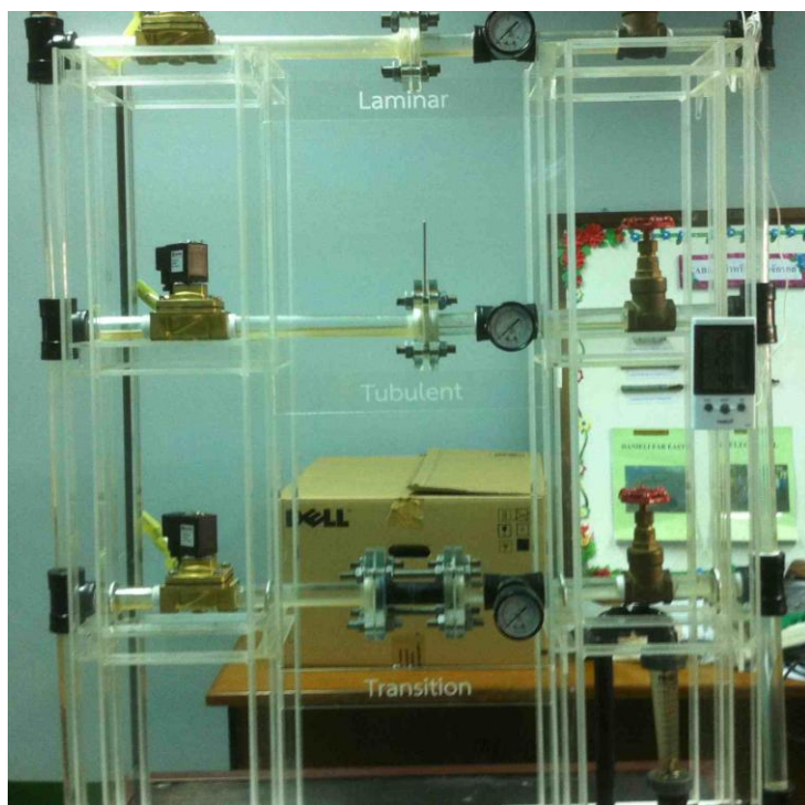
รูปที่ ก. 2 แสดงรูปโครงสร้างชุดสาธิตอัตราการไหลของของไหล
