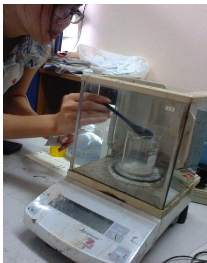
รูปที่ 3.17 แสดงการชั่งผงตัวอย่างที่ร้อนผ่านตะแกรงเบอร์ 20 ในบีกเกอร์ ประมาณ 10 กรัม
