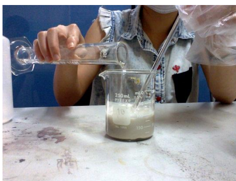
รูปที่ 3.19 แสดงการเติมกรดไนตริก ( \text{HNO}_3 ) เจือจาง (1:1) ปริมาณ 25 มล.
