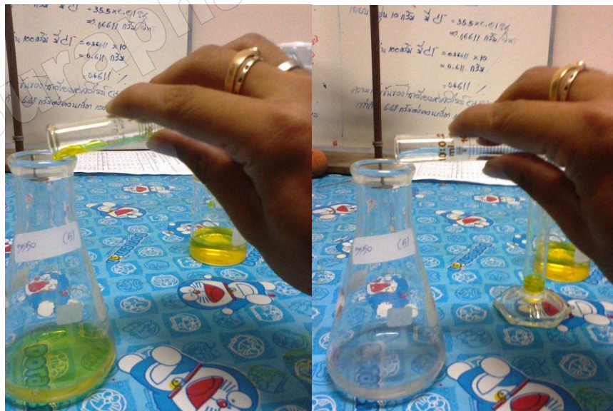
รูปที่ 3.25 เติมสารละลายโพแทสเซียมไดโครเมต ( K_2CrO_4 ) 5% ลงไป 1 มล. และเติมสารละลายโซเดียมไฮโดรเจนคาร์บอเนต ( NaHCO_3 ) 2% ลงไป 10 มล.
