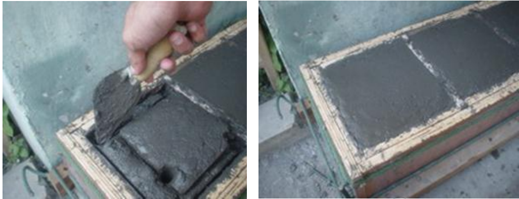
(ก.) ใช้เกรียงเกลี่ยคอนกรีตสดให้เต็มแบบหล่อ (ข.) ตกแต่งผิวหน้าคอนกรีตให้เรียบ รูปที่ 3.12 แสดงการหล่อคอนกรีตขนาด 200 \times 200 \times 250 \text{ mm}^3 . เมื่อ 15 ปีที่แล้ว
