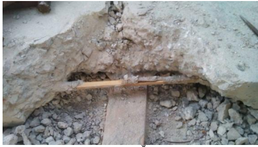
การวัดของไม้ไผ่เสริมในพื้นที่คอนกรีตเสริมไม้ไผ่เคลือบอีพ็อกซีพื้นทราย
