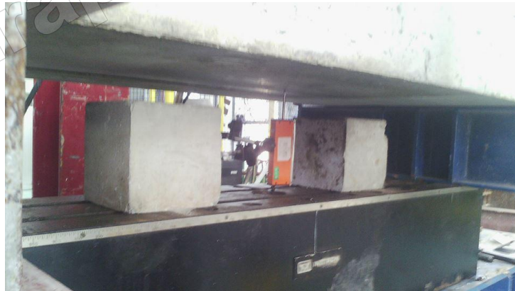
รูปที่ ข-10 การติดตั้ง Displacement Transducer
