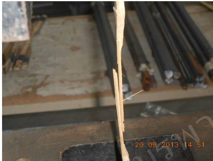
รูปที่ 5.2 วิบัติที่บริเวณตรงกลางรอยคอด โดยไม้ไผ่จะแตกตามแนวขนานเส้น
