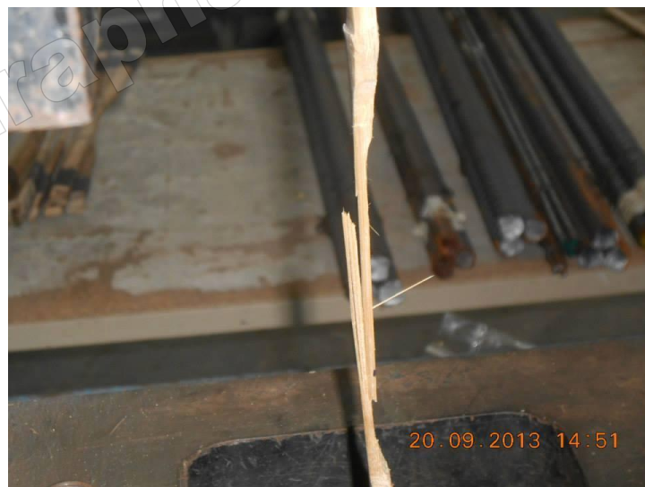
รูปที่ ข-2 การดิ่งไม้ไผ่เพื่อหาค่าลึงรับแรงดิ่ง
