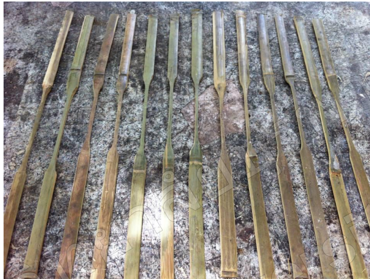
รูปที่ ข-1 ตัวอย่างชิ้นไม้ไผ่ก่อนนำไปทดสอบหาค่าลึงรับแรงดิ่ง
