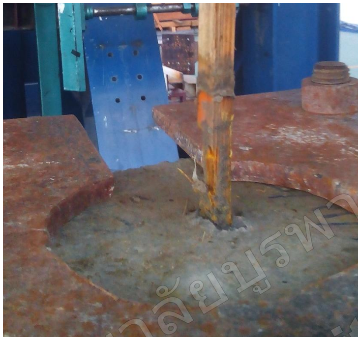
รูปที่ 5.4 ไม้ไผ่รูดออกจากคอนกรีต
